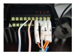
Wenn Spannung (3-5V) liegt, BMS und Kabel sind in Ordnung ----- SYS COM PORT am WR defekt. Wenn keine Spannung gelesen ----- Kabel ODER BMS defekt. Dann gehen Sie zum Punkt 3.
